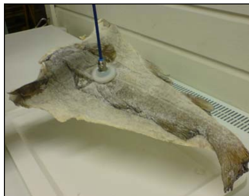
Figur 16. Håndtering av klippfisk ved bruk av vakuumgriper. Fisken til venstre gripes fra kjøttsiden, mens fisken til høyre gripes fra ryggsiden. På begge bildene benyttes vakuumkopper med 40 mm diameter.
