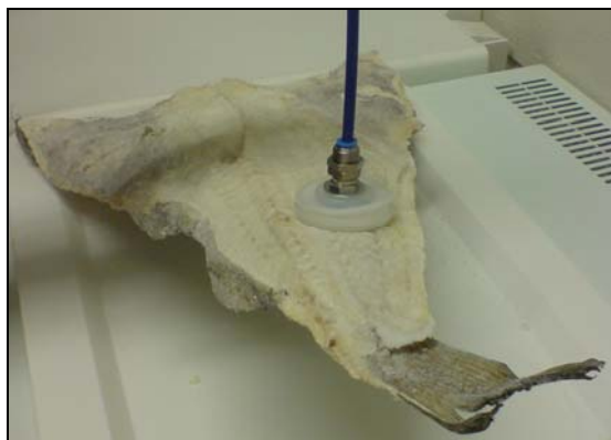
Figur 16. Håndtering av klippfisk ved bruk av vakuumgriper. Fisken til venstre gripes fra kjøttsiden, mens fisken til høyre gripes fra ryggsiden. På begge bildene benyttes vakuumkopper med 40 mm diameter.
